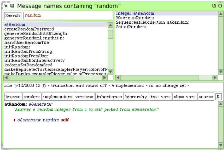
FIG. 6.32 – Le Method Names Browser montrant toutes les méthodes contenant le sous-élément de chaîne random dans leur sélecteur.
