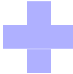
FIG. 11.6 – Le morph en forme de croix présente une ligne de pixels non remplis.
