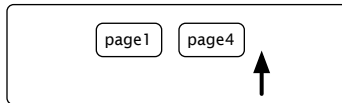
FIG. 10.11 – Depuis la page 1, l'utilisateur clique sur un lien vers la page 4. L'historique oublie les pages 2 et 3.
