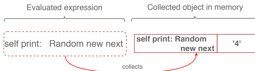
FIGURE 5.1 – Un collecteur : l'encadré en pointillé représente le point de collecte (à gauche), dont le résultat de l'évaluation (un objet) est collecté à l'exécution. Le résultat en mémoire est visible à droite : la case de gauche représente l'expression instrumentée et la case de droite la valeur collectée qui annote cette expression.
